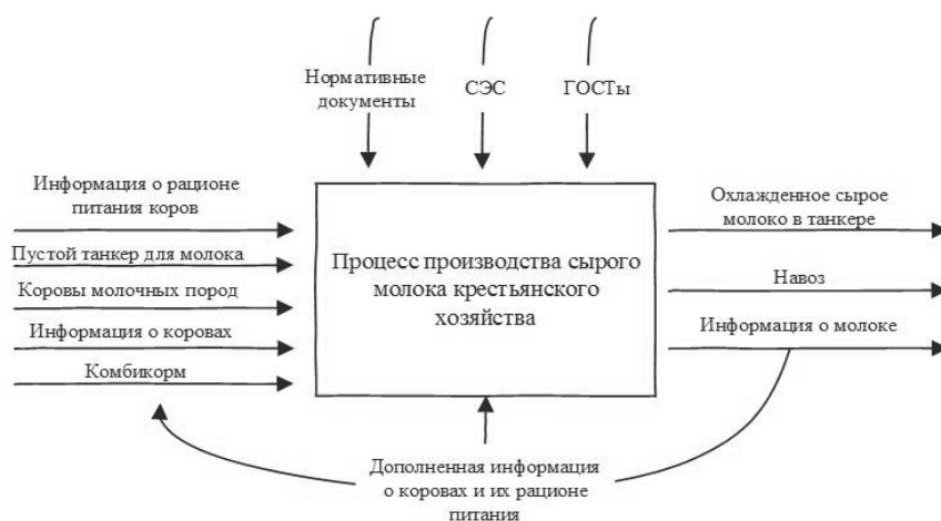
Рисунок 3 – Модель черного ящика процесса производства сырого молока, рассматривающая материальные и информационные потоки
