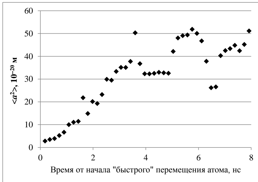
Рис. 1. Средний квадрат смещения атома ксенона \langle a^2(t) \rangle на участках высокой подвижности в \text{UO}_2 при T = 3025 \text{ К}
