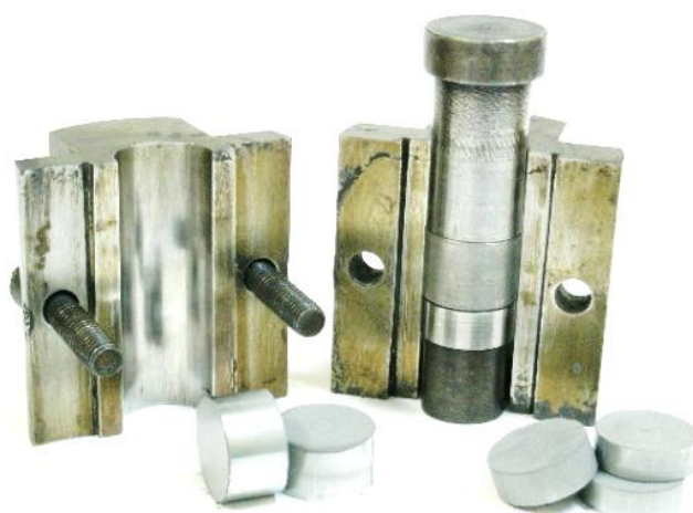
Рис. 1. Инструментальная оснастка и брикеты порошка сплава ЦМ-2А.
