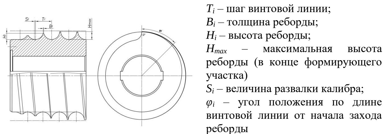
Рис.8. Модель шаропрокатного вала
