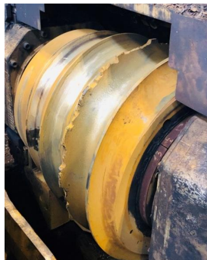
Рис. 2. Вид изношенной поверхности в зоне скрещивания
