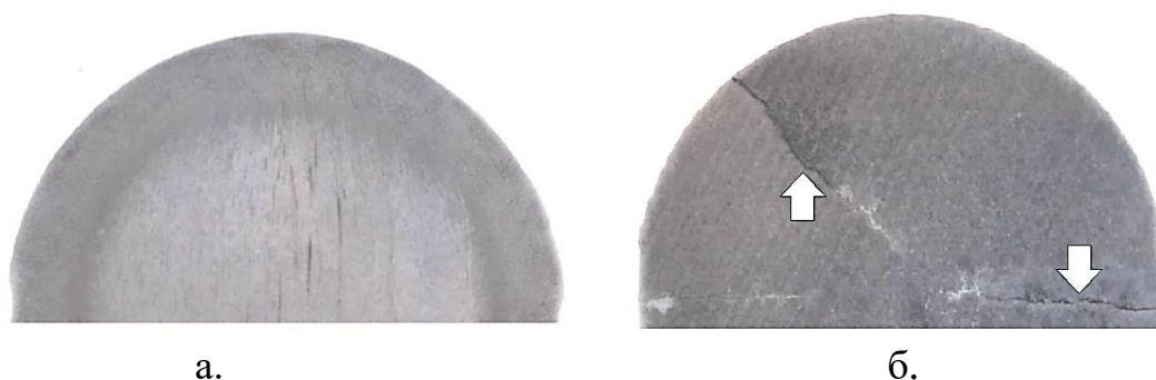
Рис. 15. Сравнительный анализ макроструктуры мелющих шаров: а.- сталь Ш-3Р, б. - 75ХГФН Стрелками обозначены трещины, возникшие в результате термической обработки.
