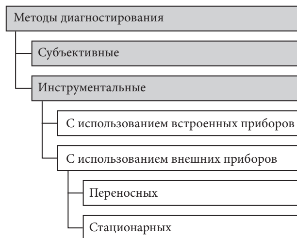
Рис. 1. Методы диагностирования двигателей внутреннего сгорания [1; 5]
