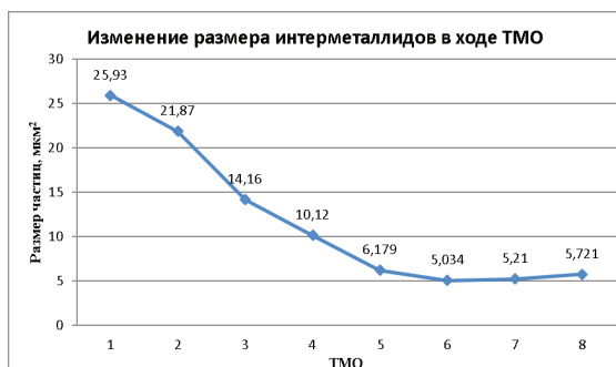
Рис. 1. Изменение размеров крупных частиц интерметаллидов в зависимости от типа ТМО (слева) и их внешний вид (справа: а — 1; б — 2; в — 3; г — 4; д — 5; е — 8)
