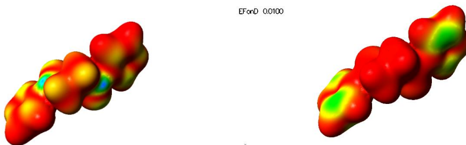
Рисунок 2. Рассчитанные поверхности нуклеофильной и электрофильной восприимчивости для молекул 1,1'-сукцинилди(имидазола)
