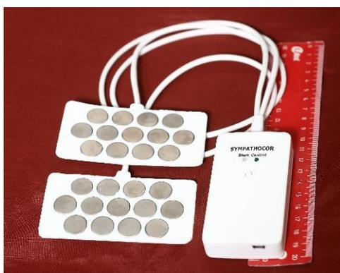
Рисунок 4 – Фотография электродной системы с блоком стимуляции (первого модуля).
