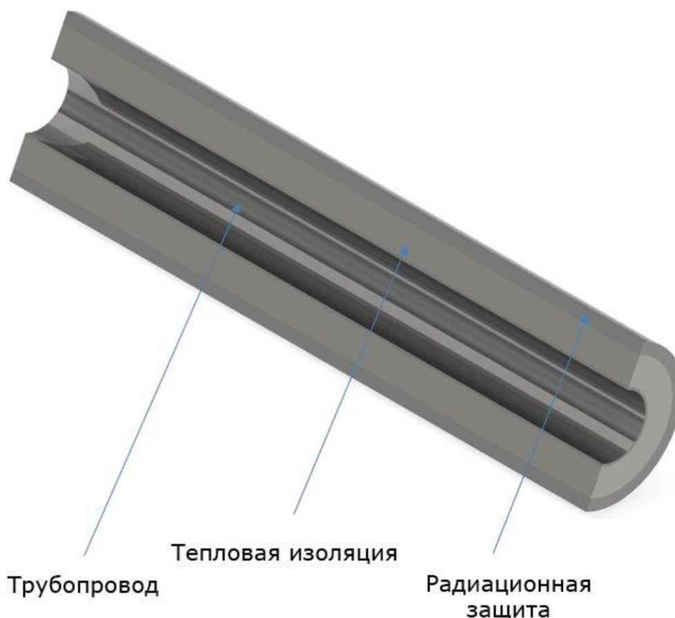
Рисунок 1 – Модель участка трубопровода с тепловой изоляцией и радиационной защитой
