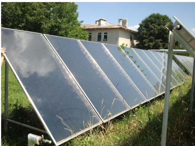
Рис. 1. Плоский солнечный коллектор CFK-1
