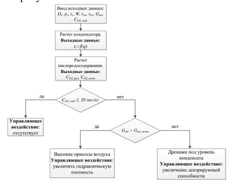
Блок-схема алгоритма анализа причин повышенного содержания кислорода в основном конденсате после конденсатора
