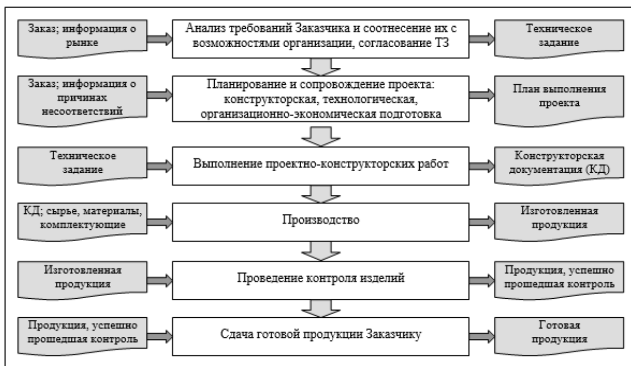
Рисунок 5 – Основные этапы изготовления габаритно-весовых макетов приборов
