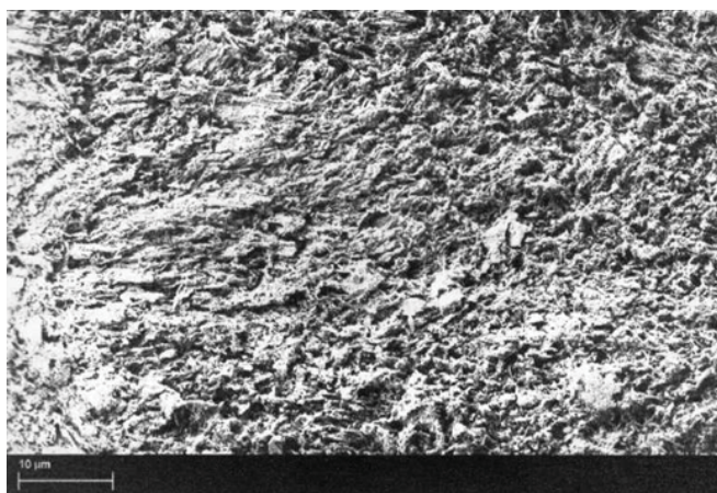
Рис. 3. Поверхность образца метеорита Чинге после бактериального воздействия и обработки 1 % HCl
