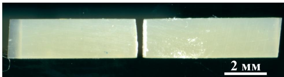
Рисунок 2 – Поверхность образца Filtek Ultimate после испытания
