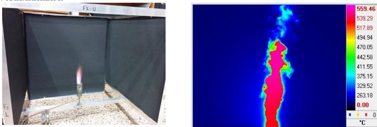
Рис. 2. Слева – фотография горящего диффузионного факела, формируемого прямоточной горелкой в режиме непрерывной подачи газообразного топлива; справа – визуализация ИК-тепловизионного изображения на первом кадре ИК-тепловизионной последовательности
