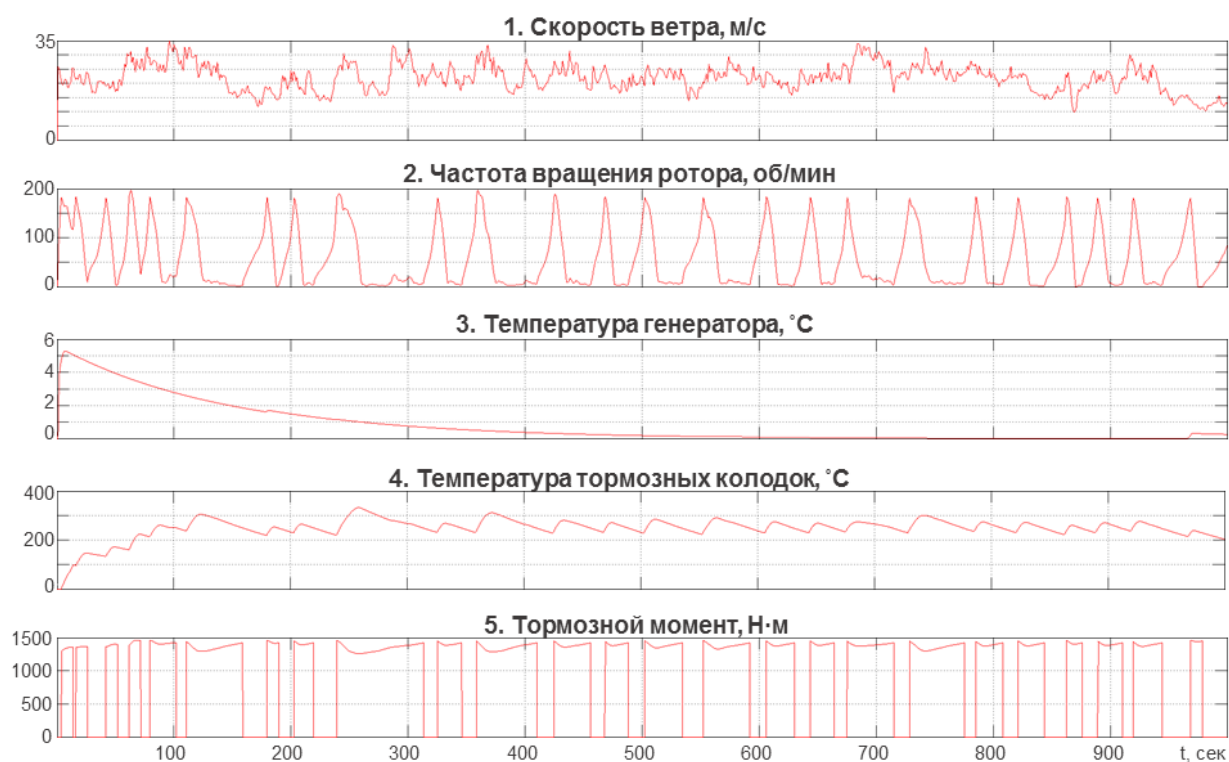
Рисунок 9 – Результаты компьютерного моделирования работы системы торможения ВЭУ-3 при переменной скорости ветра с отдельными порывами до 35 м/с и средним значением 21,9 м/с (в MATLAB Simulink).
