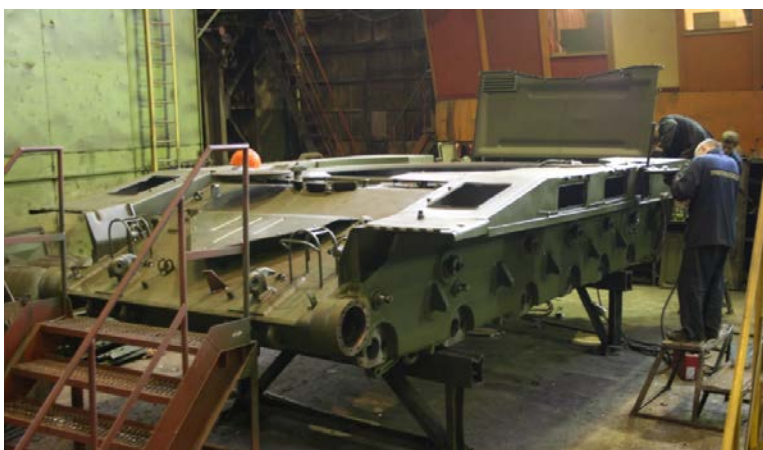
Рис. 30. Однодуговая механизированная сварка в труднодоступных местах
