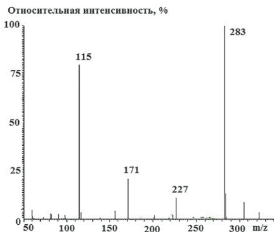
Рис. 2. Масс-спектр (ES) трибутилтиофосфата ( M = 282 , t_R = 14.31 мин). Отнесение пиков: m/z = 283 [\text{M}+\text{H}]^+ , 227 [\text{M}+\text{H}-\text{C}_4\text{H}_9]^+ , 171 [\text{M}+\text{H}-2\text{C}_4\text{H}_9]^+ , 115 [\text{M}+\text{H}-3\text{C}_4\text{H}_9]^+ ° [\text{P(OH)}_3\text{SH}]^+ . Сигналы с m/z = 305 и 322 принадлежат ионам [\text{M}+\text{Na}]^+ и [\text{M}+\text{K}]^+ , соответственно.
