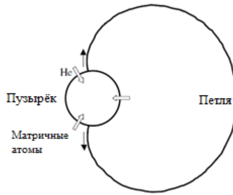
Рисунок 1.10 – Схематическое представление взаимодействия комплекса пузырьков – дислокационная петля [59]
