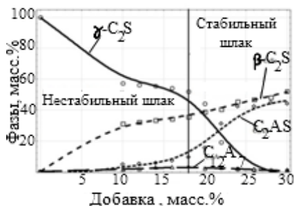
Рисунок 4 – Изменение содержания фаз при введении добавки в синтезированный \text{C}_2\text{S}
