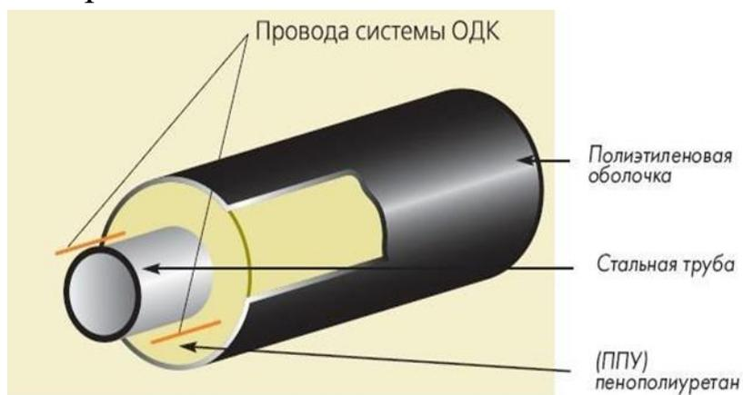
Рис. 1. Схема нанесения пенополиуретановой изоляции (ППУ) на трубопровод
