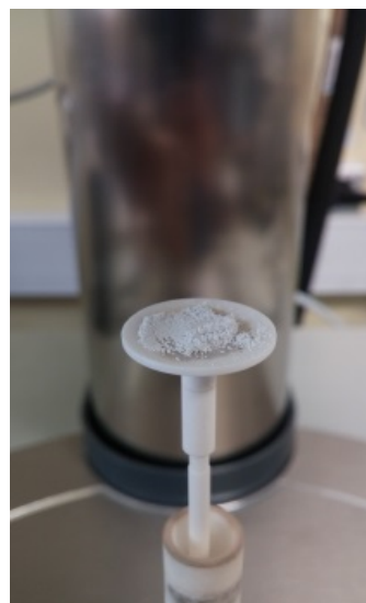
Рис. 2. Навеска термогравиметрического анализатора с чистой окисью цинка
