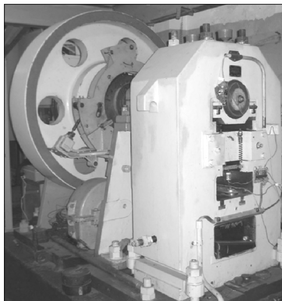
Рис. 1. Общий вид кулачкового пластометра разработки ИМАШ УрО РАН
