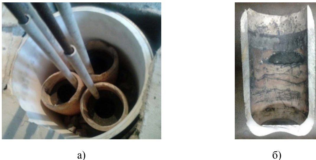
Рисунок 3.13 – Опытный электролизер с образцами керамических диафрагм:
