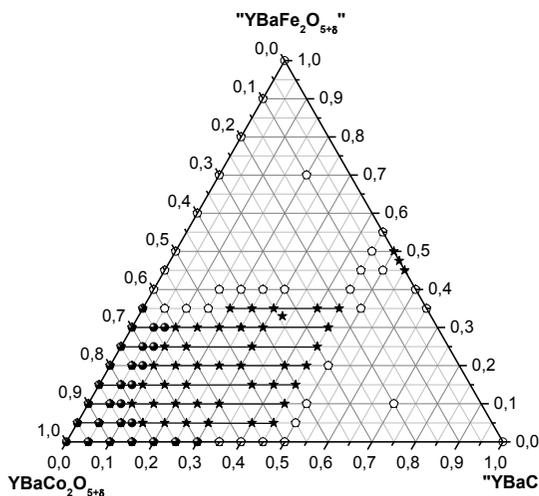
Иллюстрация составов сложных оксидов  $\text{YBaCo}_{2-y-z}\text{Fe}_y\text{Cu}_z\text{O}_{5+\delta}$  при 1273 К на воздухе
