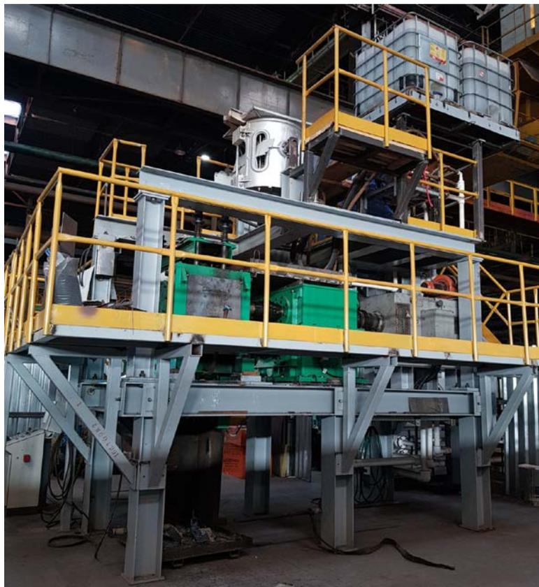
Рисунок 11– Установка непрерывного литья и деформации ОАО «Уральский трубный завод»
