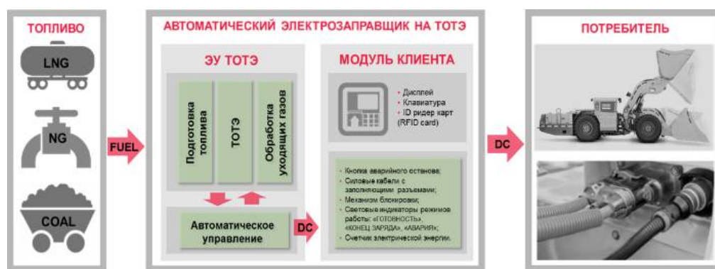
Рис. 4. Схема взаимодействия энергетической установки на ТОТЭ и потребителя электроэнергии SCOOPTRAM ST7 BATTERY на горно-добывающем предприятии. (Изображение с сайта http://uicpro.ru/napravleniya-raboty/proekty-dlya-neftegazovogo-sektora/ )
