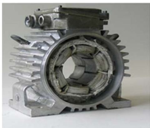
Рис. 1. Статор опытного образца АДAM новой конструкции, разработанного в ЗАО «Уралэлектромаш»
