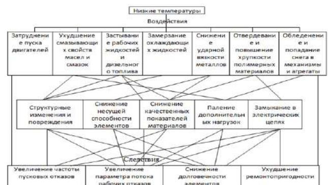
Рис. 2. Схема воздействия низких температур на автомобиль
