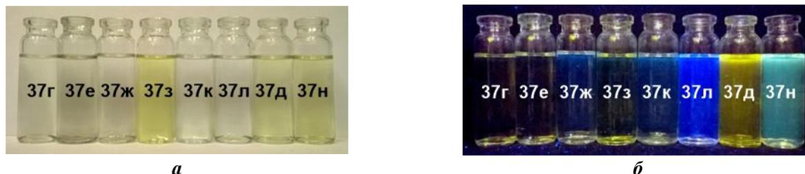
Рис. 2.9. Фотографии растворов тиазолов **37г-з,к,л,н** в 1,4-диоксане при дневном свете (*а*) и облучении светом с  $\lambda=380$  нм (*б*)
