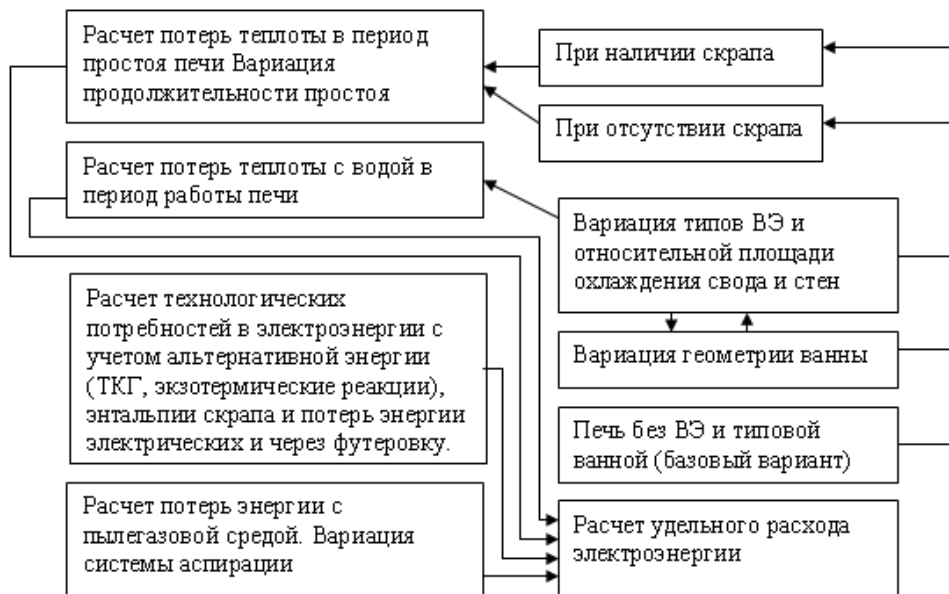
Рис. 2. Блок схема математической модели поиска энергоэффективных решений ДСП литейного класса.
