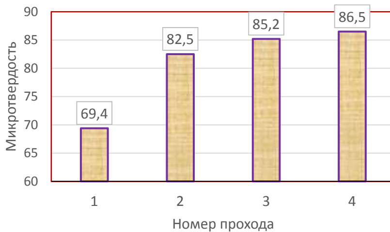
Рис. 3. Микротвердость поверхности серебряной проволоки по проходам скальпирования
