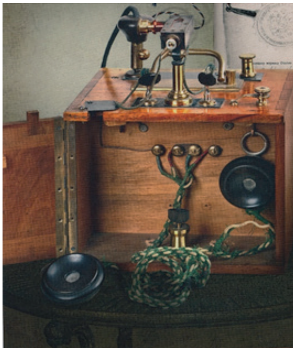
Телефонный приемник А. С. Попова (1899). Изготовлен фирмой Э. Дюкрете (Франция)
