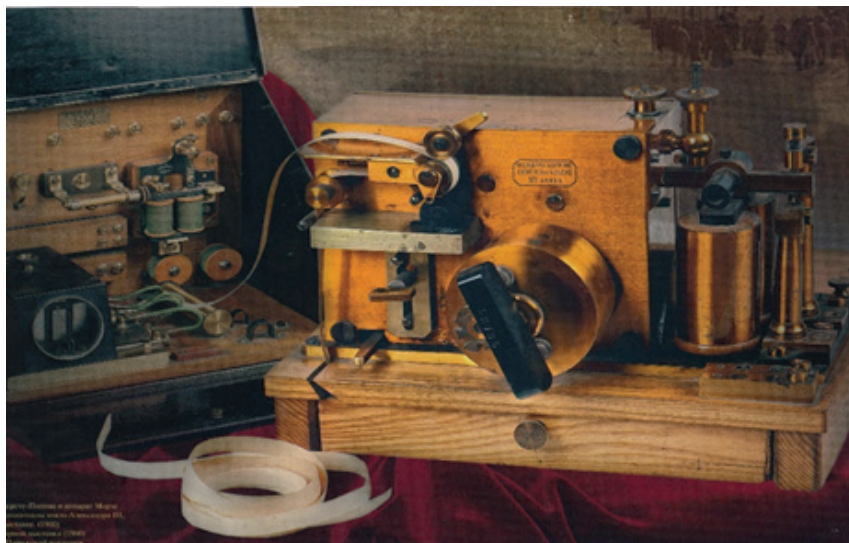
Приемник А. С. Попова с подключенным телеграфным аппаратом Морзе
