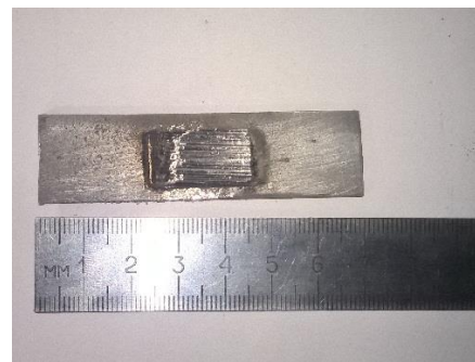
Рис. 4. Испытание на износ образца упрочненного ВЗК
