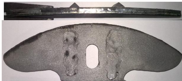
Рис. 5. Нанесенное покрытие ВЗК на деталь «Нож»
