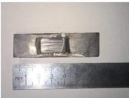
Рис. 3. Испытание на износ образца стали 45
