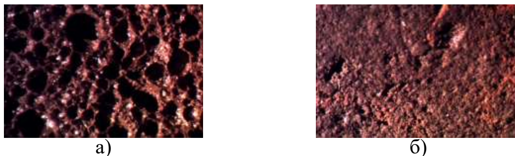
Рис. 1. Микрофотографии пористых материалов, срез (увеличение 40 раз): а – гранулированное пеностекло; б – керамзитовый гравий
