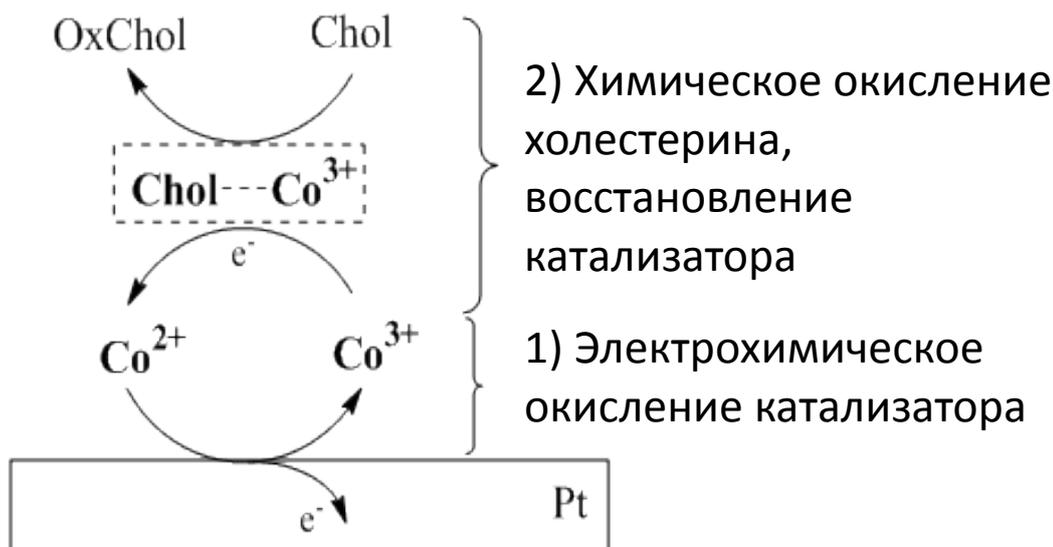
Рисунок 4.18 – Схема электроокисления холестерина в присутствии катализатора –  $\text{CoCl}_2$  в ацетонитриле на поверхности ПДЭ, где  $\text{Chol}$  – холестерин;  $\text{Co}^{3+} \cdots \text{Chol}$  – аддукт, образующийся в процессе электрокаталитической реакции между катионом металла и молекулой холестерина;  $\text{OxChol}$  – окисленный холестерин (возможно, хлорпроизводные холестерина), образующийся в результате реакции
