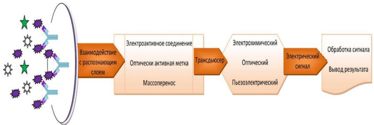
Рисунок 1.16 – Базовая схема иммуносенсора
