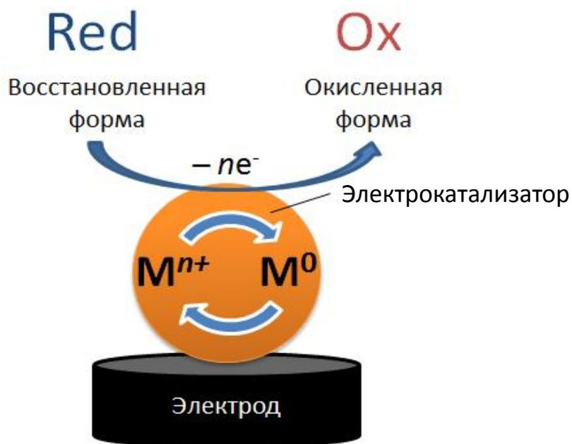
Схема 4.1 – Механизм электрокаталитического окисления аналита
