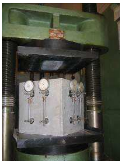
Рисунок 3.2.6 - Испытание прочности образца ПСБ на местное сжатие при центральном нагружении: а) общий вид; б) характер разрушения образца
