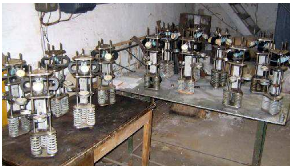
Рисунок 4.6.1 - Общий вид пружинных установок с образцами-призмами из ПСБ, испытываемыми на ползучесть при длительном действии нагрузки
