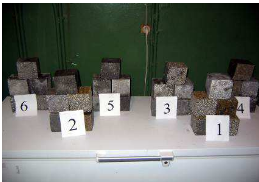
Рисунок 5.2.1 – Общий вид 6 серий контрольных образцов-кубов ПСБ после проведения испытаний на циклическое замораживание и оттаивание
