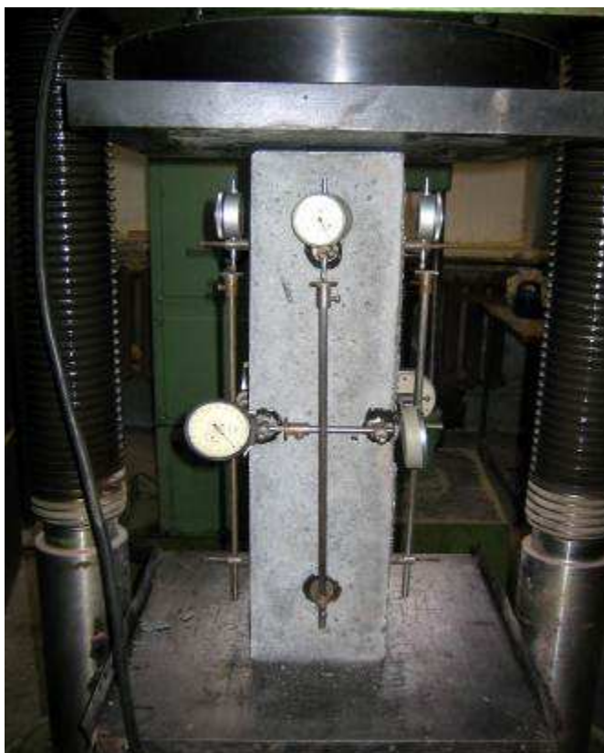
Рисунок 3.2.3 – Испытание призмной прочности на сжатие образца-призмы из конструкционного полистиролбетона размером 150x150x600 мм с определением значения начального модуля упругости
