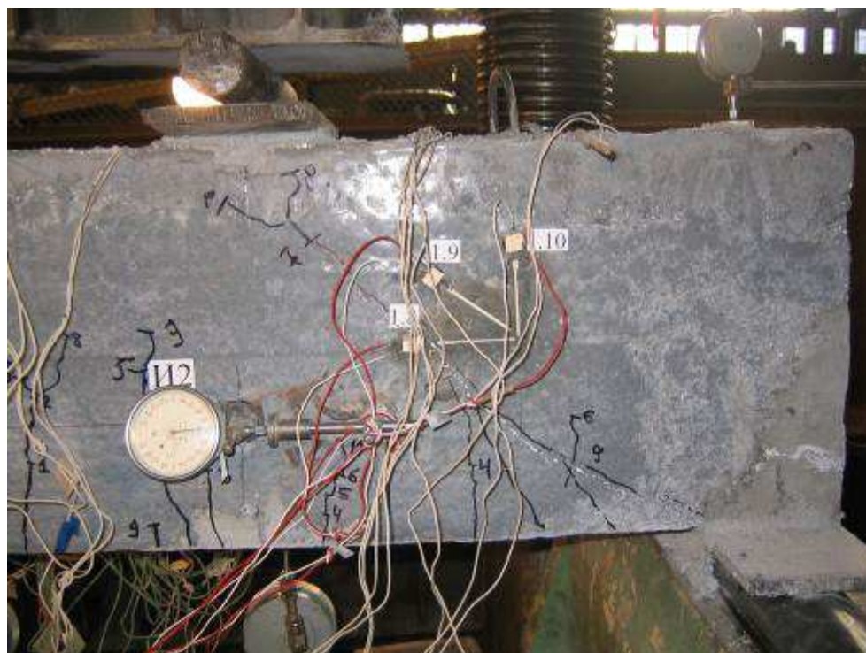
Рисунок 6.2 – Характер трещинообразования материала в стадии разрушения при испытании на изгиб несущей балки - перемычки из ПСБ с \gamma_{\text{ср}}=1220 \text{ кг/м}^3 и кубиковой прочностью на сжатие соответствующей классу В7,5
