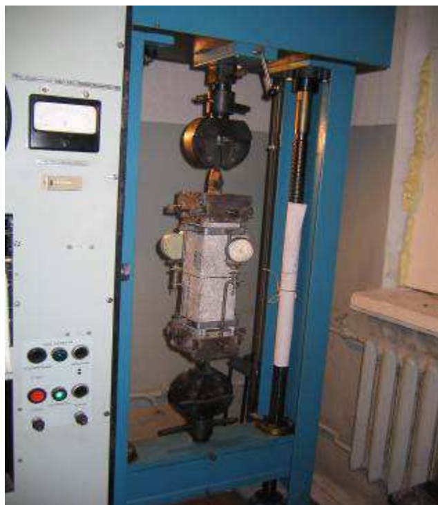
Рисунок 3.3.1 - Испытание прочности образца - призмы из полистиролбетона размером 100x100x400 мм на осевое растяжение с помощью Испытательной разрывной машины Р-5
