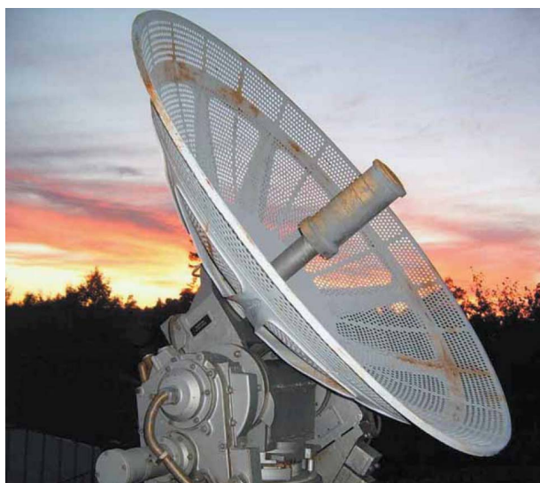
Рис. 7. Антенна РЛС системы радиозондирования АВК-1-МРЗ Fig. 7. The radar antenna of radiosounding system AVC-1-MRZ
