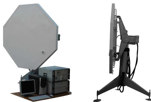
Рис. 10. Комплект аппаратуры комплекса «Вектор-М» (слева) и вид сбоку на РЛС «Вектор-М» (справа).
