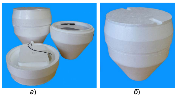
Рис. 11. Общий вид радиозондов MRZ-N1 (а), MRZ-ZAK1 (б).
