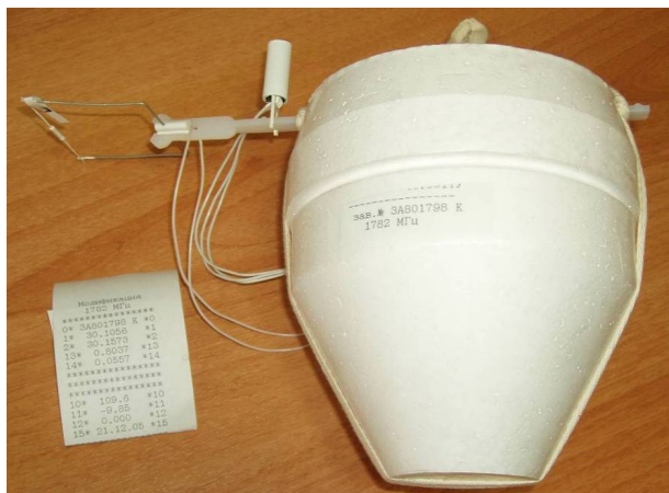
Рис. 13. Состав (сверху вниз), внутренняя «начинка» и внешний вид в предполётной готовности радиозонда МРЗ-3МК.
