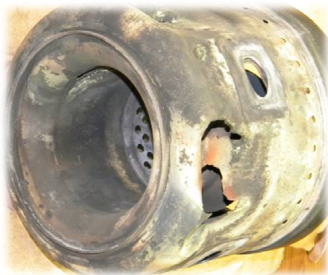
Рисунок 2.1.1 – КС установки С-65
