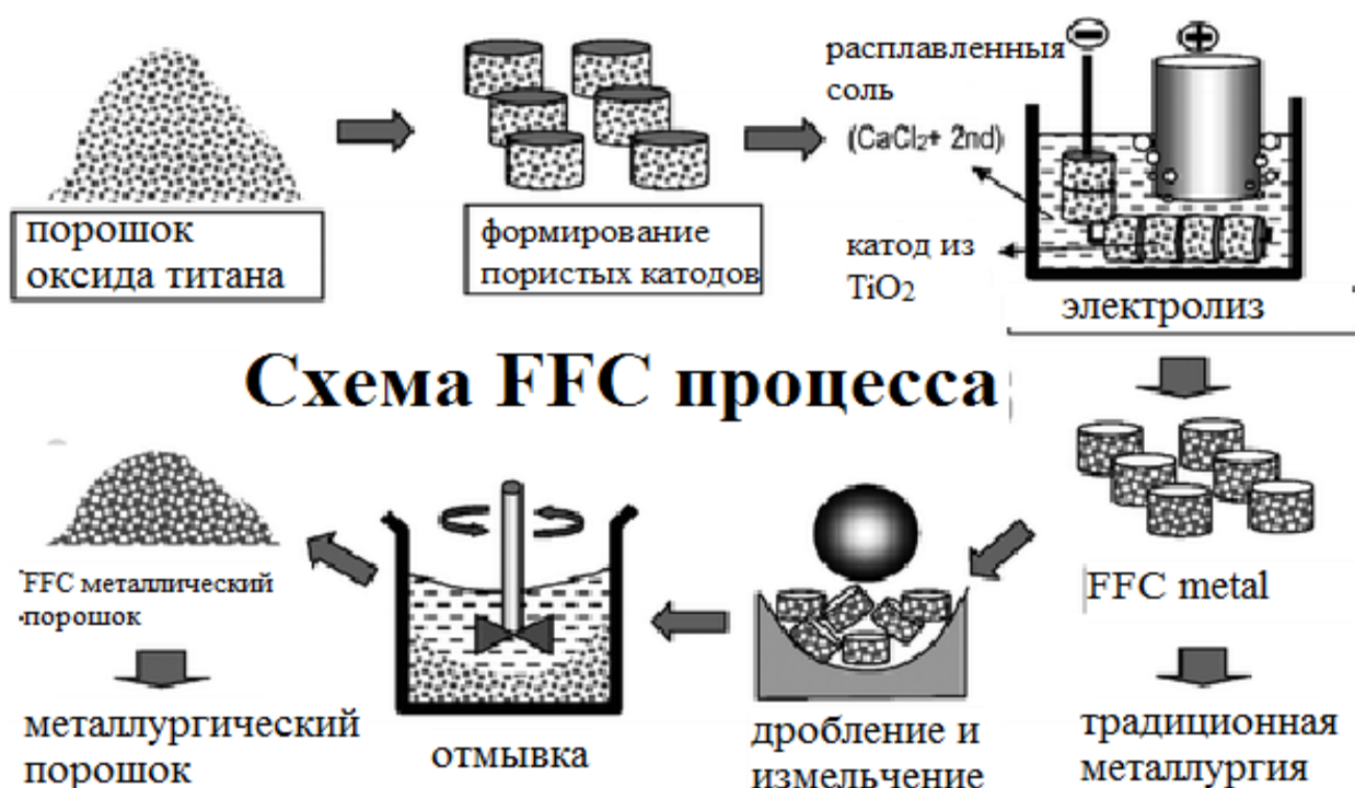
Рисунок 5.1 – Схематическое описание FFC - Кембридж процесса
