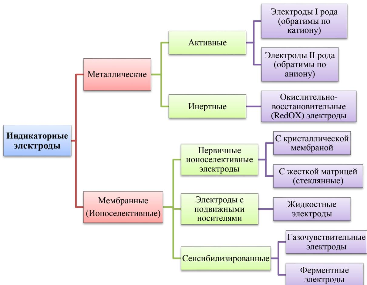
Рисунок 2 - Классификация индикаторных электродов, используемых в потенциометрии согласно ИЮПАК
