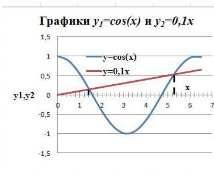
Рис.5. Графический способ отделения корня уравнения  $\cos x = 0,1x$  на отрезке  $[0; 6,5]$
