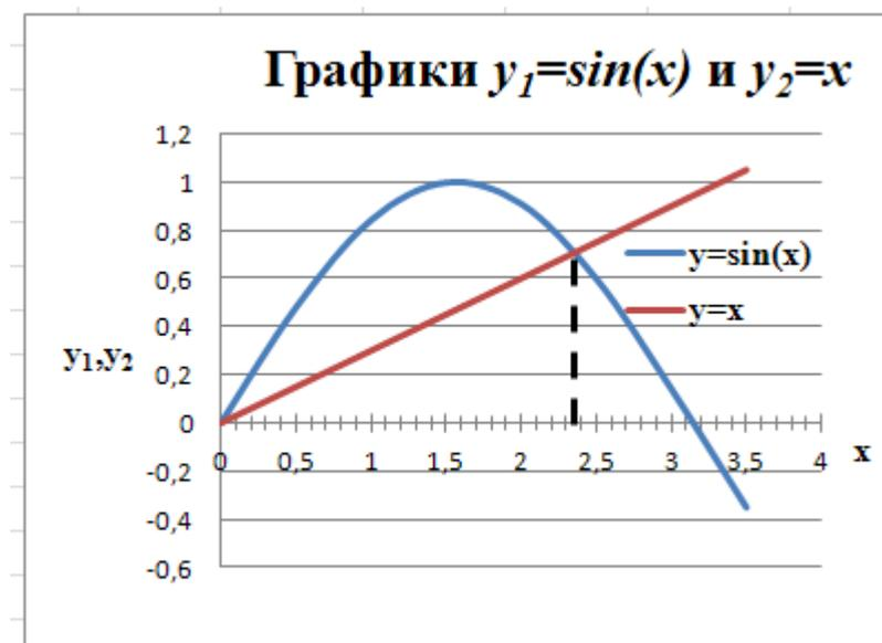
Рис.4. Графический способ отделения корня уравнения  $\sin x = x$  на отрезке  $[0; 3,5]$
