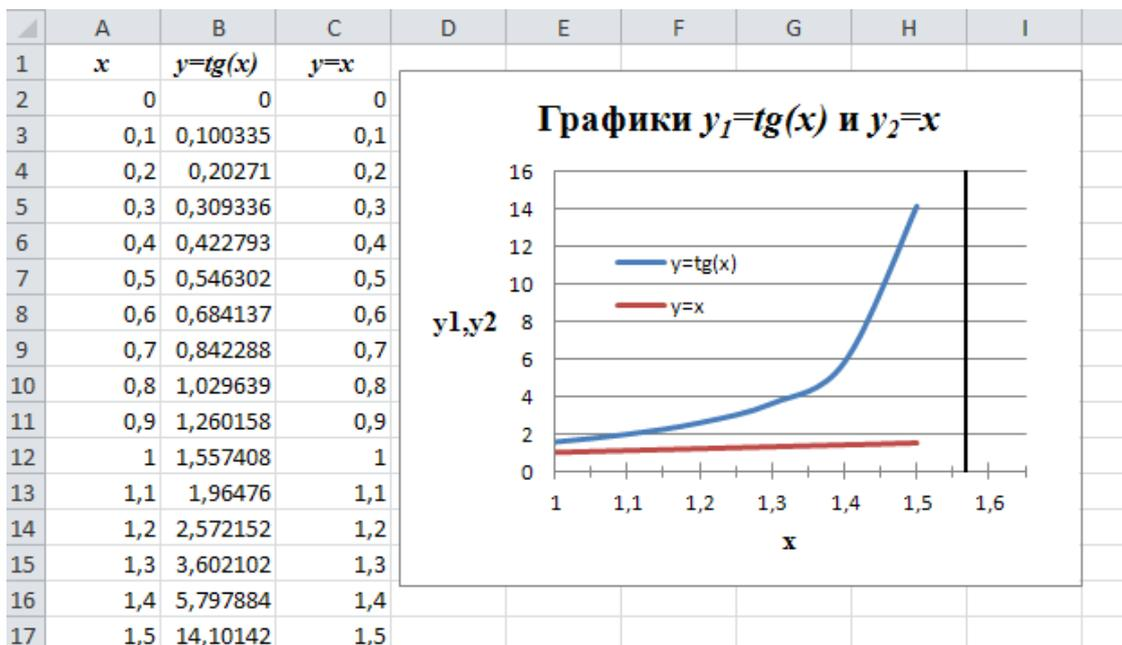
Рис.1. Графический способ отделения корня уравнения  $\operatorname{tg}x = x$  на отрезке  $[0; \pi/2]$
