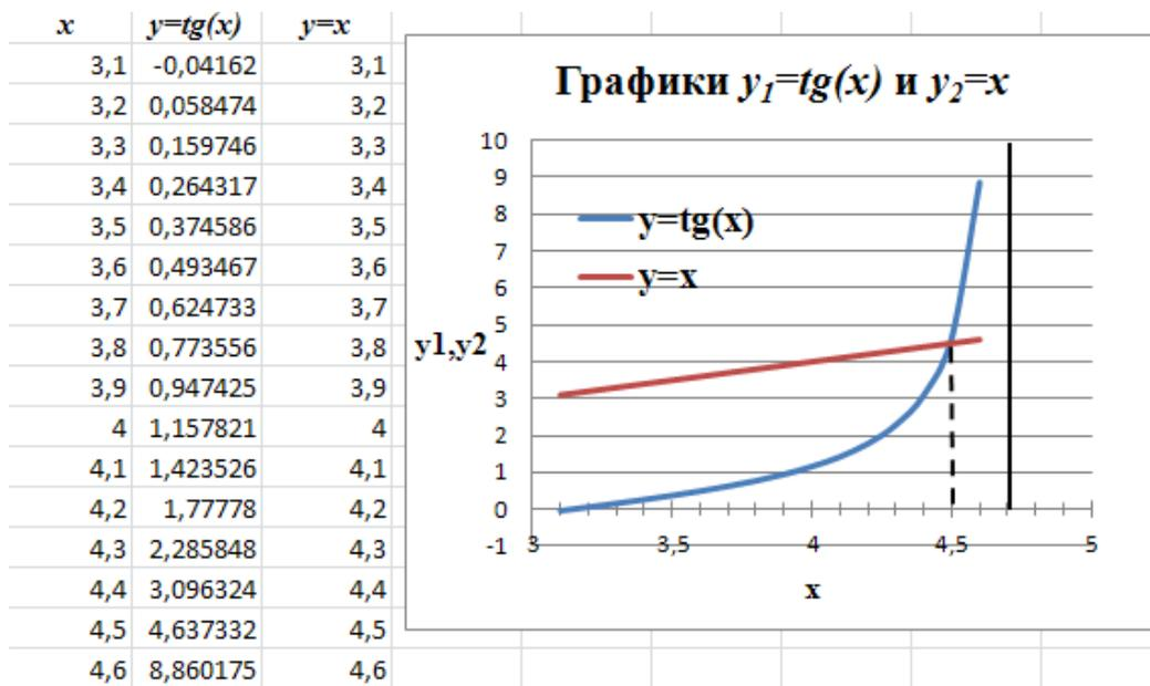
Рис.2. Графический способ отделения корня уравнения  $\operatorname{tg}x = x$  на отрезке  $[\pi; 3\pi/2]$
