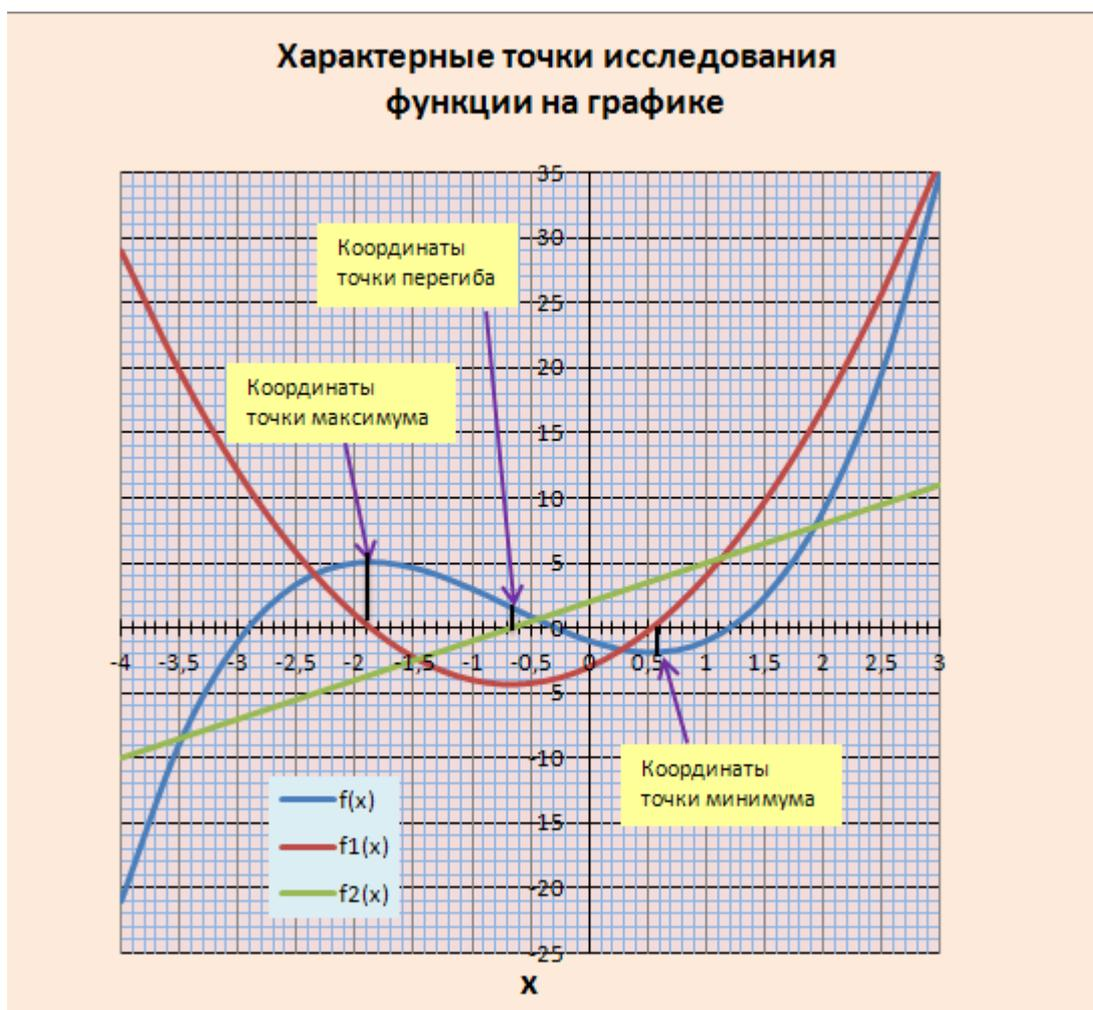
Рис.39. Точечная диаграмма, отображающая ряды значений величин  $x$ ,  $f(x)$ ,  $f1(x)$  и  $f2(x)$  и характерные точки на графике функции вида
