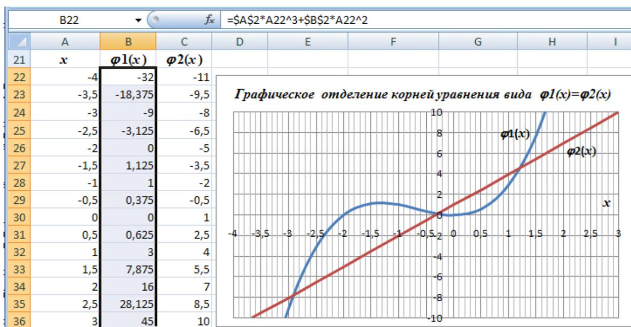
Рис. 16. Электронная таблица графического отделения корней уравнения вида  $\varphi_1(x) = \varphi_2(x)$
