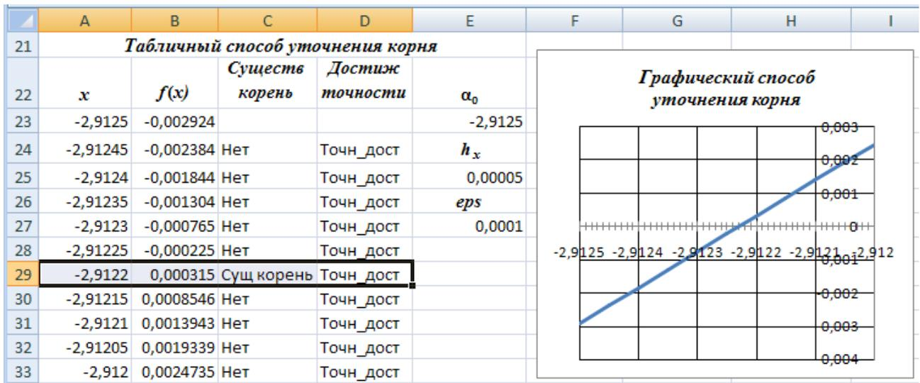
Рис. 20. Достижение заданной точности уточнения корня табличным и графическим способами
