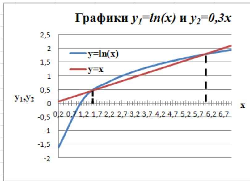
Рис.3. Графический способ отделения корня уравнения  $\ln x = 0,3x$  на отрезке  $[0,2; 7,0]$
