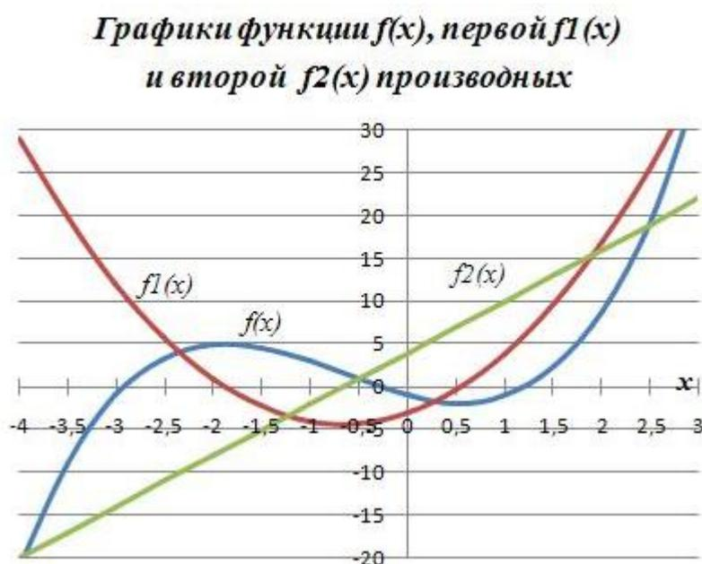
Рис. 27. Точечная диаграмма, отображающая ряды значений  $x_i$ ,  $f(x_i)$ ,  $f1(x_i)$  и  $f2(x_i)$
