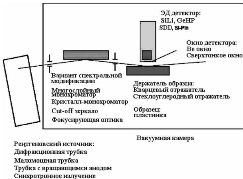
Рис. 3. Схематическое устройство TXRF установок
