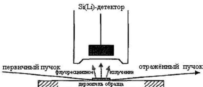
Рис. 1. Принцип действия рентгеновского спектрометра с полным внешним отражением
