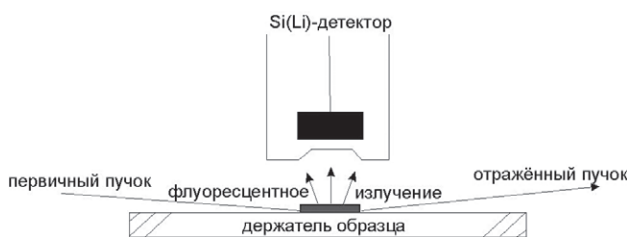
Рис. 2. Принцип действия рентгеновского спектрометра с полным внешним отражением [60]
