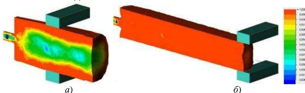
Рис. 3. Изменение относительной плотности (пористости) изделия: а) в конце первой подоперации; б) в конце пятой подоперации
