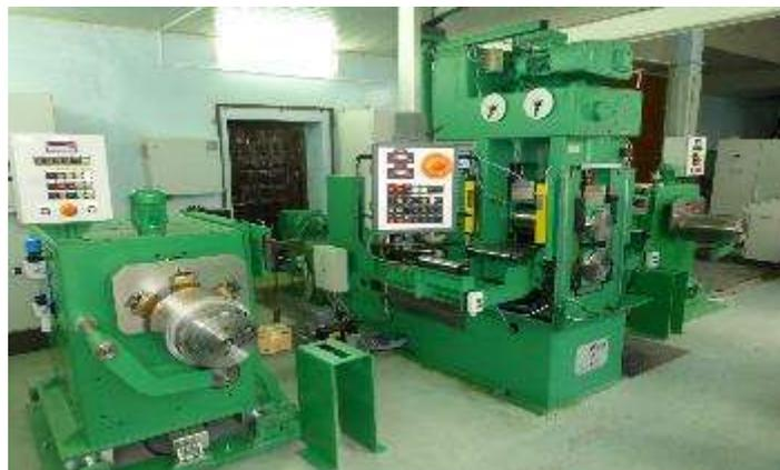
Рис. 1. Лабораторный стан DIMA 300
