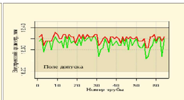
Рис. 5. Разброс максимального и минимального внутреннего диаметра труб
