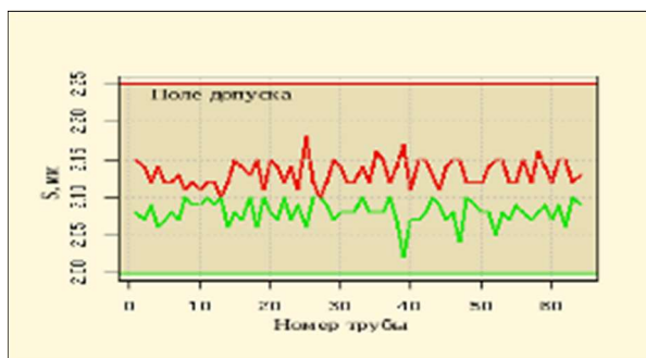
Рис. 4. Разброс максимальной и минимальной толщины стенки труб
