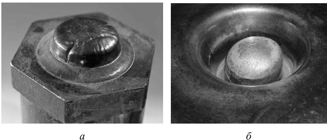
Рис. 1. Внешний вид изношенной гравюры штампового инструмента за счет разгарных трещин ( а ) и пластической деформации ( б )
