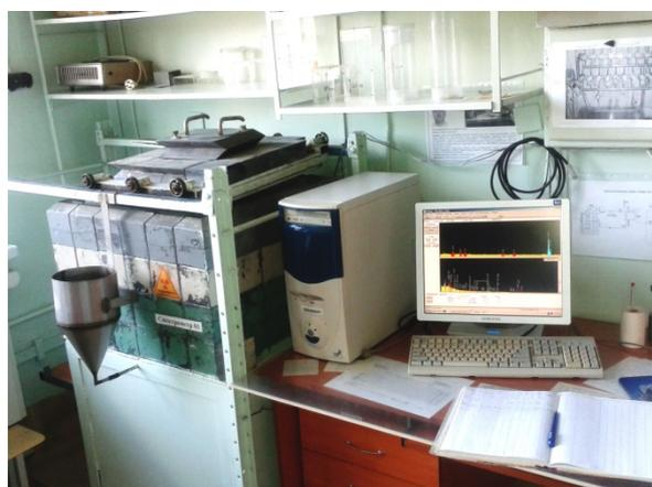
Рис. 1. Гамма-спектрометрический комплекс
