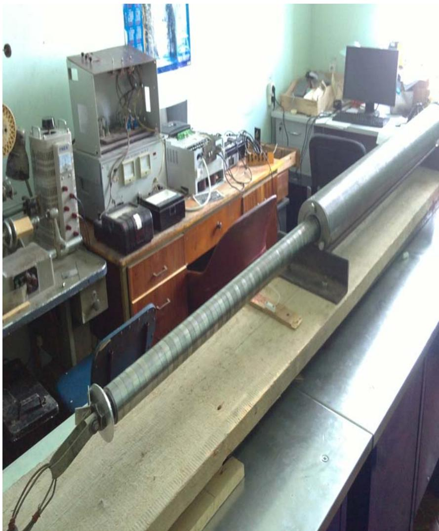
Рис.2. Стенд для динамических испытаний работы привода ЦЛВД
